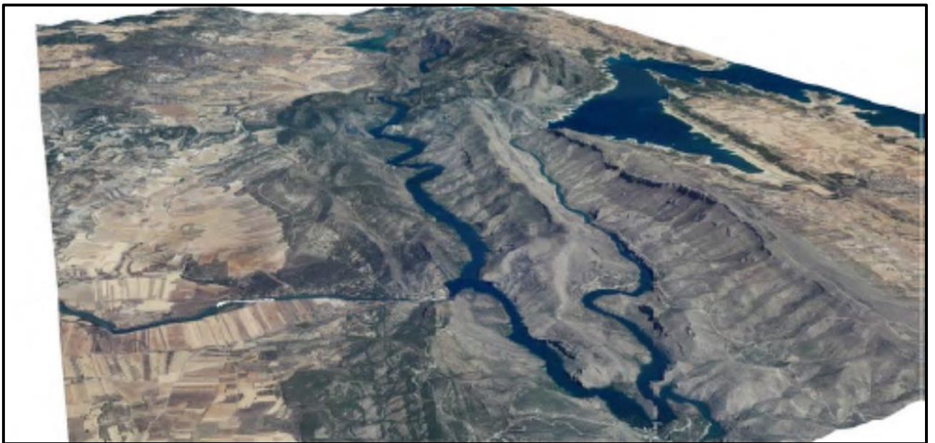
Figura 40. Relieve Jurásico conforme. Montaje en perspectiva del entorno de las presas de Buendía y Bolarque. Se aprecia claramente cómo ambas presas han sido construidas aprovechando cluses en antifirmas. También se distinguen perfectamente los cauces paralelos del Tajo (pantano de Bolarque) y del Guadiela (garganta del Guadiela) instalados en sinfirmas. Separando los dos cauces, una antifirma: la Sierra de Enmedio.
